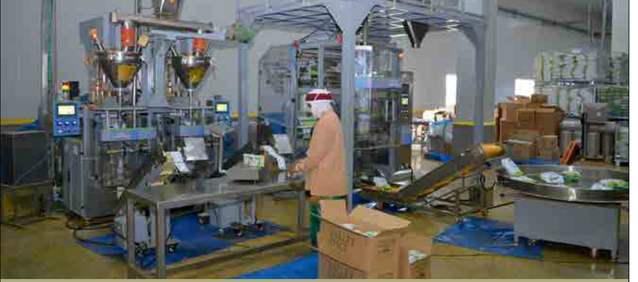
जैन फार्मफ्रेश कंपनीच्या मसाला प्रकल्पात मसाल्याचे एक किलोचे पाऊचेस स्वयंचलित यंत्रामार्फत भरले जातात.
